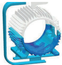
초기(위) 및 최적화된(아래) 게이팅 시스템으로 포집된 가스 결함
